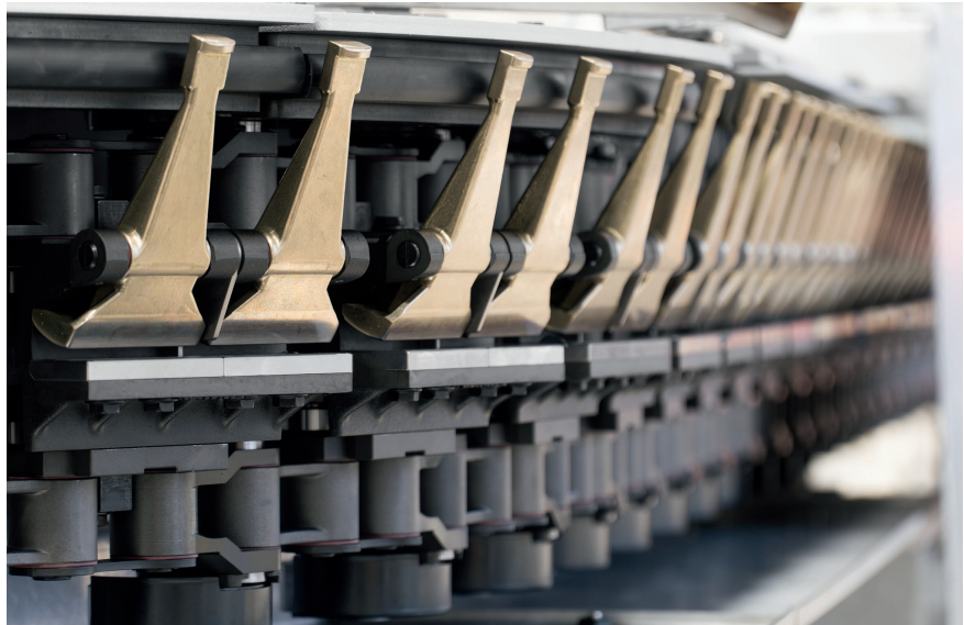
Bild 1. Nachhaltig durch Langlebigkeit: Die TDO-Ketten mit dem patentierten Kluppensystem, die die Folie greifen und durch die Anlage transportieren, lassen sich auch in bis zu 50 Jahre alten Anlagen durch Umbauten an neue Anforderungen anpassen (© Dornier)
